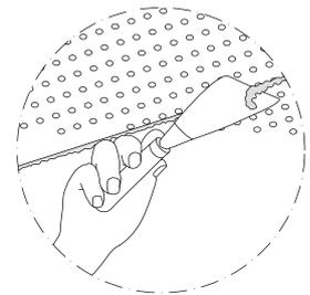
Después del proceso de fraguado del Uniflott (1 hora aprox.), proceder a retirar todo el material sobrante, recortándolo y luego repasar el tratamiento de juntas (2º mano).
