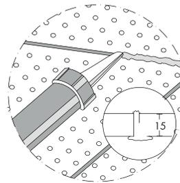
Realizar el tratamiento de juntas aplicando la pasta Uniflott con un dosificador. Rellenar por completo la ranura hasta que el Uniflott sobresalga (1º mano).
