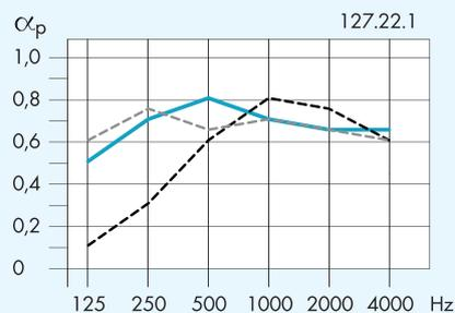
MEDICIÓN EN CÁMARA DE AIRE DE 65 mm.
