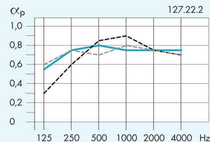
MEDICIÓN EN CÁMARA DE AIRE DE 65 mm.
