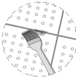
Una vez acabado el montaje, se limpia el polvo del interior de la junta de 2-4 mm. Con un pincel y luego se debe aplicar la imprimación PYL Alicatado.
