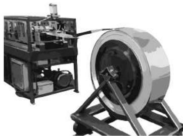
El proceso de rolado garantiza un radio interno mínimo que no produce quiebres en la capa de protección galvanizada ni disminución del espesor de la lámina.
