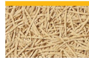
Placa acústica de fibra de madera ligada con magnesita (ancho de fibra aprox. 3 mm)
