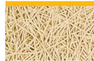
Placa acústica de fibra de madera ligada con magnesita (ancho de fibra 2 mm)
